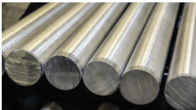
Научно-производственный комплекс предназначен для серийного производства литых прутковых заготовок (до 400 тонн в год) из жаропрочных сплавов на никелевой основе для последующего изготовления рабочих и сопловых лопаток и других литых деталей газотурбинных двигателей и установок.
