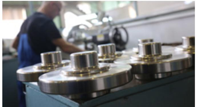
Участок изотермической штамповки НИЦ «Курчатовский институт» – ВИАМ оснащен специализированными прессами и изотермическими установками, которые позволяют изготавливать опытно-промышленные и серийные партии штамповок дисков и других деталей. Участок малотоннажного производства листового проката и горячекатаных прутков, организованный во ВЭТЦ ВИАМ, позволяет получать полуфабрикаты в виде листов, лент и прутков.
