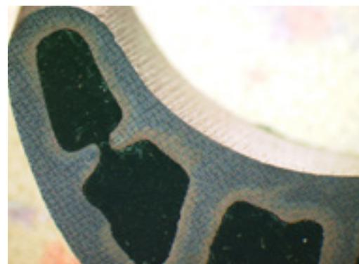
Литейные жаропрочные никелевые сплавы для изготовления деталей методом точного литья по выплавляемым моделям, в том числе турбинных лопаток с поликристаллической равноосной, направленной (столбчатой) и монокристаллической структурами.
