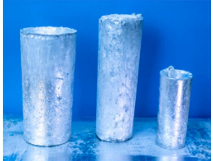
Алюминиевые сплавы и лигатуры изготавливают и поставляют в виде чушек (литьем в прямоугольные или цилиндрические изложницы) или прутков диаметром 9 мм.
