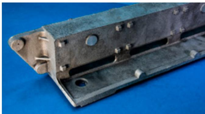
Алюминиевые отливки изготавливают методом литья в землю или по выплавляемым моделям с использованием разрабатываемой или давальческой оснастки по полному технологическому циклу – от чертежа до готовой отливки с нанесенным покрытием.
