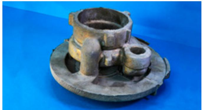
Магниевого отливки изготавливают методом литья в формы, изготовленные по технологиям ХТС и ПГС с использованием разрабатываемой или давальческой оснастки по полному технологическому циклу – от чертежа до готовой отливки с нанесенным покрытием.
