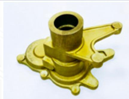
Готовая отливка с нанесенным покрытием
