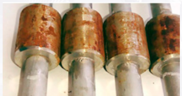
Отсутствие следов коррозии паяных соединений из сплава 12Х18Н10Т после испытаний в камере солевого тумана в течение 6 месяцев
