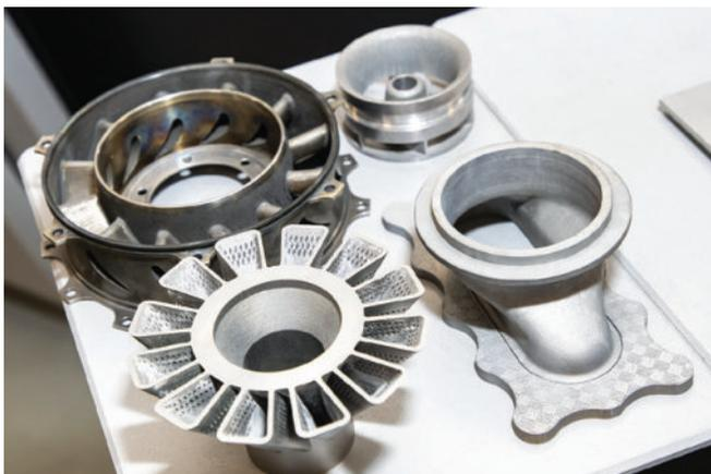
Детали горячего тракта газотурбинных двигателей изготовленные по аддитивным технологиям
