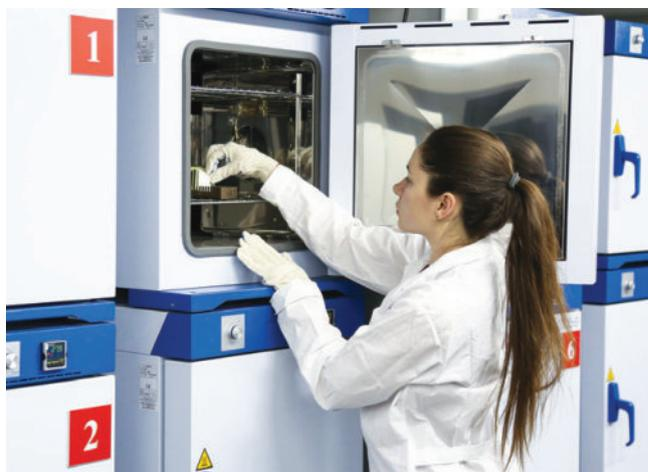
Испытания материалов на воздействие повышенных температур
