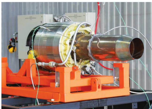
Малоразмерный газотурбинный двигатель МГТД-125, изготовленный на базе аддитивного производства ВИАМ
