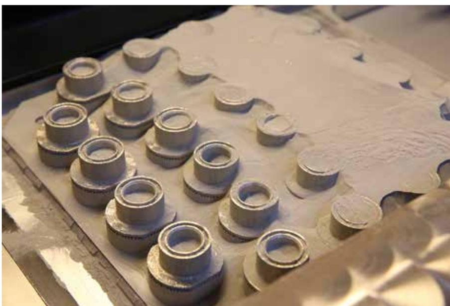
Рис. 4. Завихрители фронтального устройства камеры сгорания перспективного авиационного двигателя ПД-14
