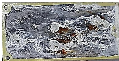
Рисунок 31 – Внешний вид образца из стали 30ХГСА размером 100×50 мм с ГТП Ц2. О1. Ц2. О1. т. хр, сформированного термообработкой при 200 °С в течение 2 ч, после 500 ч ускоренных коррозионных испытаний в КСТ
