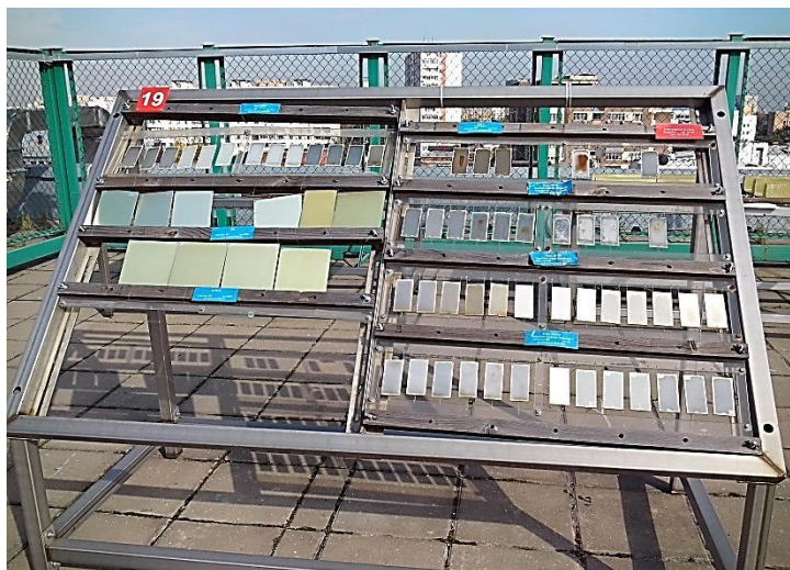
Рисунок 25 – Проведение экспозиции образцов с гальванотермическим покрытием на открытой площадке в Москве
