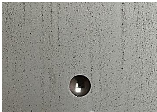
Рисунок 29 – Внешний вид ГТП Ц4. О2. т (210, 4 ч), после испытания на определение прочности методом удара на вертикальном копре
