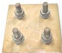
Рисунок 24 – Вид сборки болтов и гаек с пластинами: болты, гайки, шайбы М6 с пластиной из стали 30ХГСА, пластина и болты с кадмиевым покрытием.
