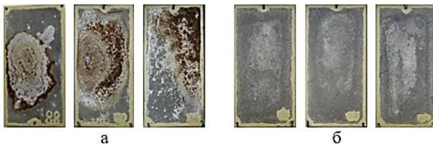
Рисунок 5 – Внешний вид образцов из стали 30ХГСА с покрытием Кд9. фос. окс. нхр (а) и ГТП Ц4. О4. Ц2 т.хр (б) после 4,5 лет экспозиции в ГЦКИ (г. Геленджик)
