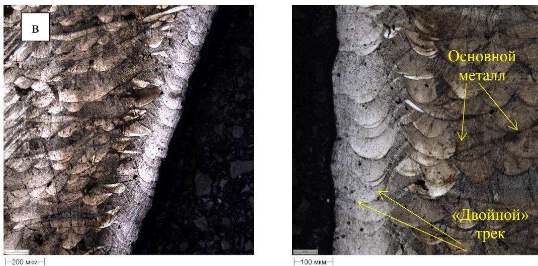
Рисунок 3.2. Микроструктура приповерхностного слоя синтезированного образца: нижняя галтель (а, х200; б, х500), рабочая часть/вертикальная поверхность (в, х200), верхняя галтель (г, х100). Оптическая микроскопия.
