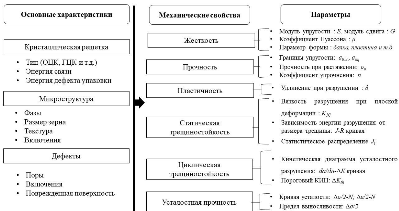
Рисунок 1.1. Соотношения между основными характеристиками материала, механическими свойствами и их параметрами.
