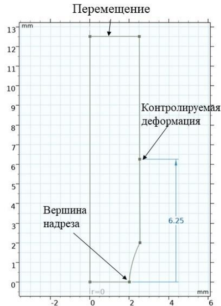
Рисунок 3.30. Схема модели для расчетов долговечности образца с надрезом.
