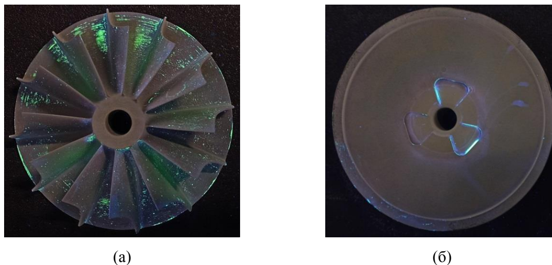
Рисунок 5.2 – Результаты капиллярного контроля поверхности крыльчатки турбины методом ЛЮМ7-ОВ после натуральных испытаний: (а) сторона лопаточного венца - прямолинейные индикации макрорельефа послойного синтеза, (б) обратная торцевая поверхность - индикации отсутствия трещин
