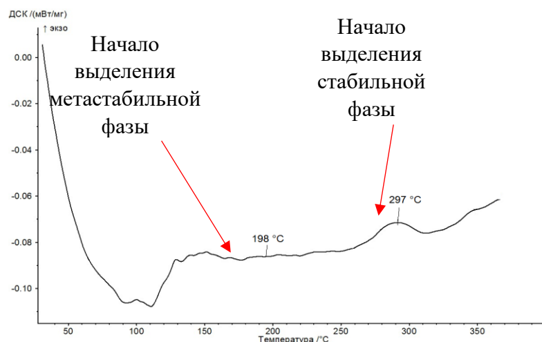
Рисунок 4.4.2. Кривые изменения ДСК сигнала закаленного образца
