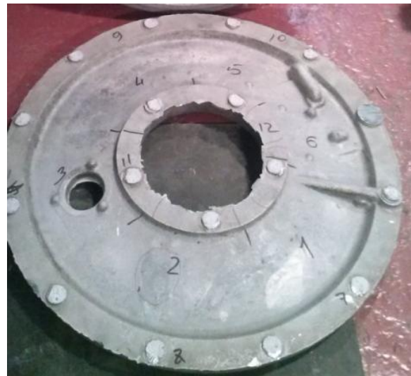
Рисунок 1.4 Корпусные детали двигателя НК-32, изготовленные из серийных жаропрочных литейных магниевых сплавов МЛ9, МЛ10, МЛ19
