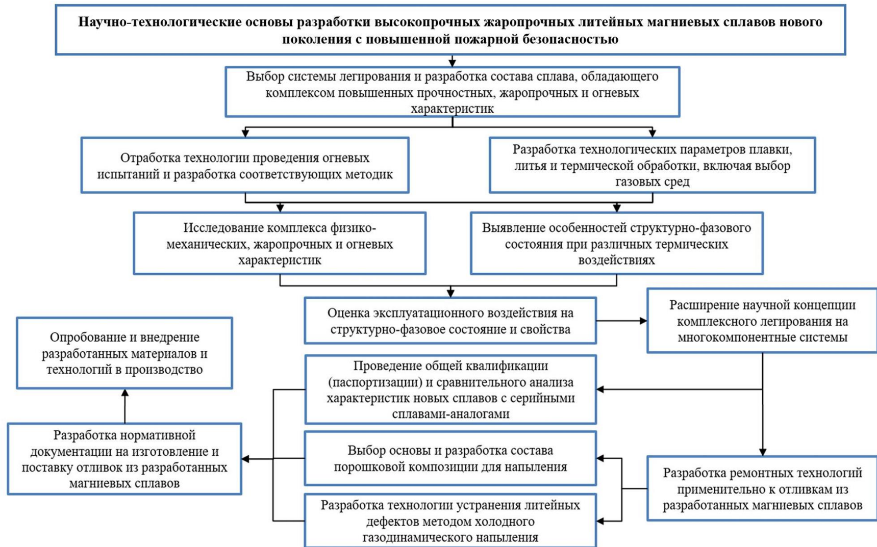
Рисунок 1.7. Структурная схема научно-технологических основ разработки высокопрочных жаропрочных литейных магниевых сплавов нового поколения с повышенной пожарной безопасностью
