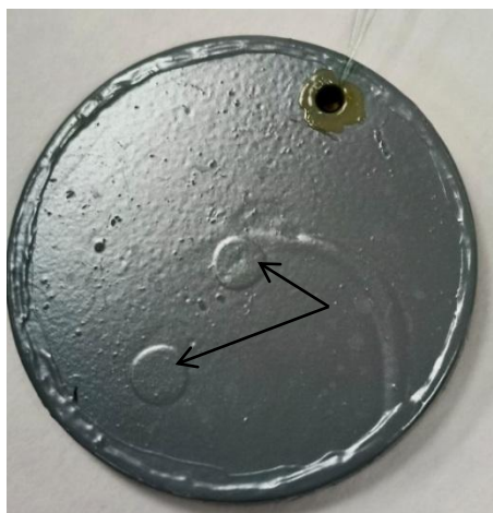
Рисунок 5.2.7. Образец после испытания на коррозионную стойкость магниевого сплава в КСТ: вид образцов из магниевого сплава ВМЛ26 без коррозионных поражений. Места напыления указаны стрелкой.
