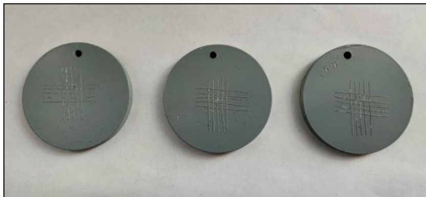
Рисунок 5.2.8. Образцы из магниевого сплава ВМЛ26 после испытаний на адгезию.
