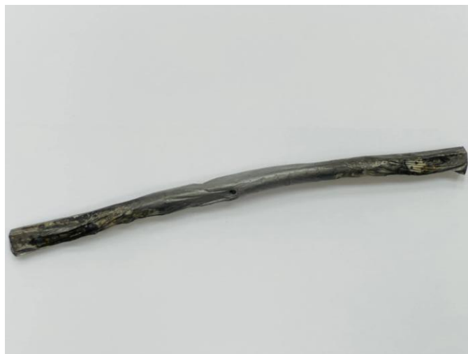
Рисунок 4.5.5. Образец из пожаробезопасного магниевых сплава ВМЛ_оп после испытаний
