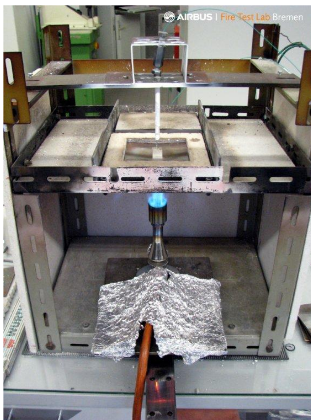
Рис.4.5.2. Малоразмерный стенд для проведения огневых испытаний на воспламеняемость образцов магниевых сплавов [214, 233]
