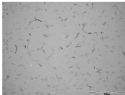
Рисунок 52 – Микроструктура сплава с цирконием
