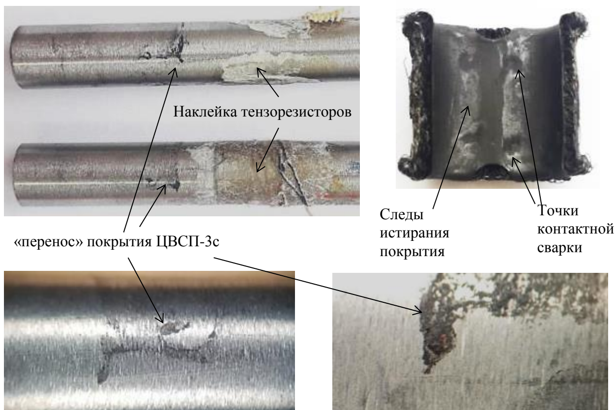
Рисунок 4.5. – Вид сопряженных поверхностей труб и втулок после виброиспытаний на этапе 3 (до промывки следов покрытия ЦВСП-3с, перенесенного с втулок).
