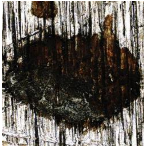
Рисунок 4.6 – Вид локальных несмываемых участков с элементами ФК на наружной поверхности образцов труб после виброиспытаний на этапе 3 после промывки следов покрытий, перенесенных с прокладок.
