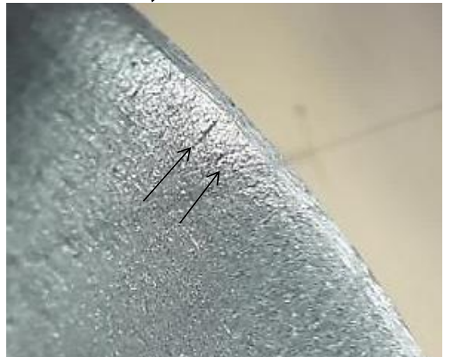
Рисунок 6.1 – Вид локальных микронадрывов (показаны короткими черными стрелками) на наружной поверхности по месту развальцовки игиба образцов труб 2-1, прошедших упрочнение стеклянной дробью по режиму 1.
