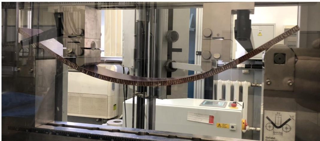
Рисунок 38 – Процесс испытания по определению разрушающей нагрузки при 4-х точечном изгибе трехслойной сотовой конструкции с обшивками из углепластика марки ВКУ-59
