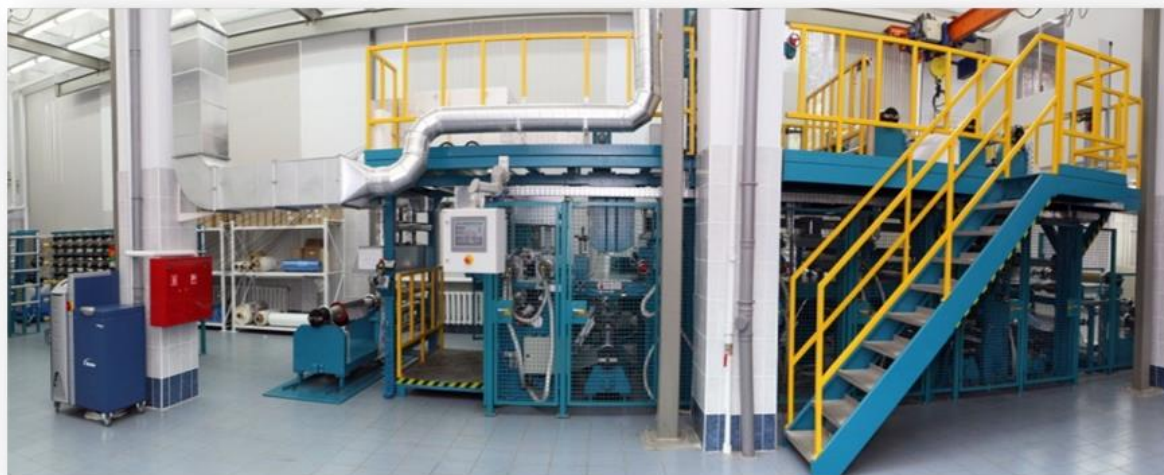
Рисунок 6 – Установка для изготовления клеевых препрегов на основе клеевого связующего пониженной горючести марки ВСК-14-6
