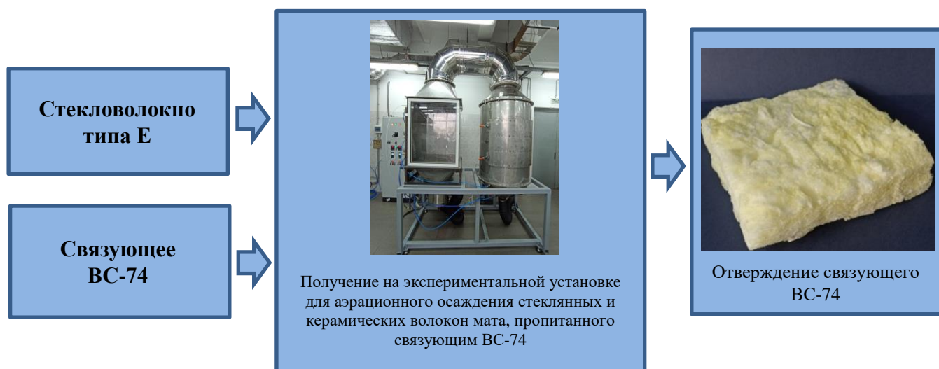
Рисунок 35 – Принципиальная схема получения гибкого волокнистого ТЗИМ марки ВТИ-29 на основе стекловолокна
