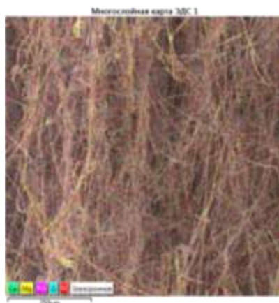
Рисунок 23 – Суммарный энергодисперсионный спектр карты, поверхности образца ТЗИМ марки Microlite AA blanket
