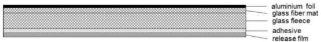
Рисунок 5 – Схема материала Isoglamat 4/21 ALU компании Steinbach AG
