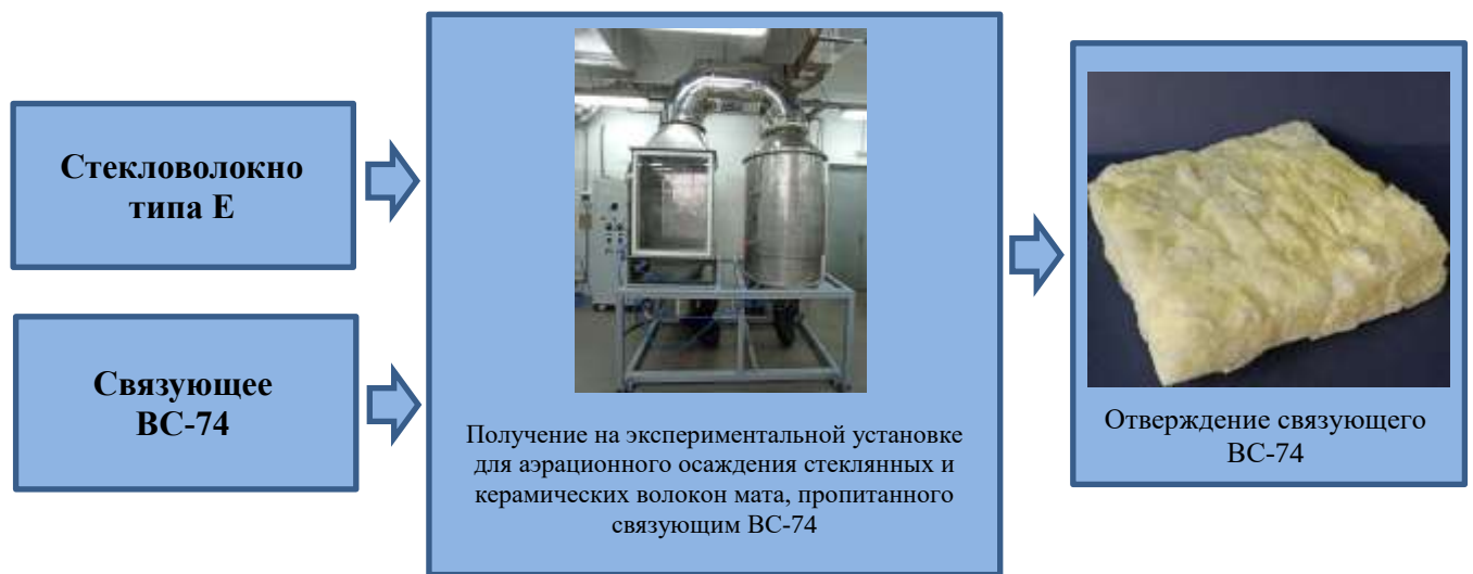
Рисунок 39 – Принципиальная схема получения гибкого волокнистого ТЗИМ марки ВТИ-29 на основе стекловолокна
