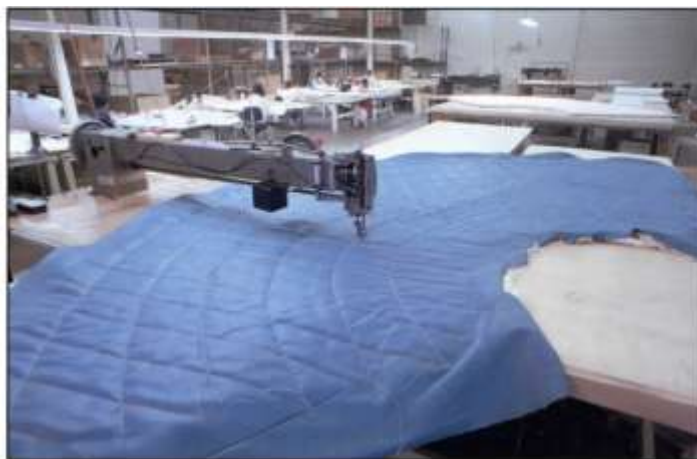
Рисунок 3 – Прошивная машина компании Hi-Temp insulation Inc. для облицовки теплоизоляции
