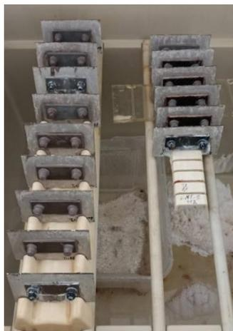
Рисунок 2.10 – Образцы КПО после выдержки 500 ч в КСТ
