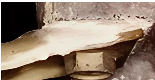
Рисунок 1.3 – Коррозия на границе (в контакте) корпуса и кронштейна
