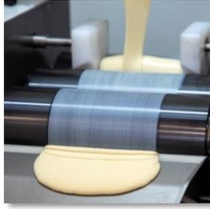
Рисунок 4.1 – Процесс перетираания компонента А
