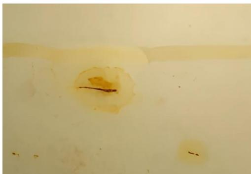
Рисунок 1.1 – Коричневые продукты коррозии стали
