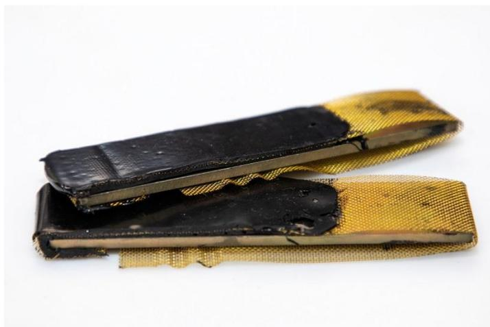
Рисунок 2.6 – Образцы для определения прочности связи при отслаивании
