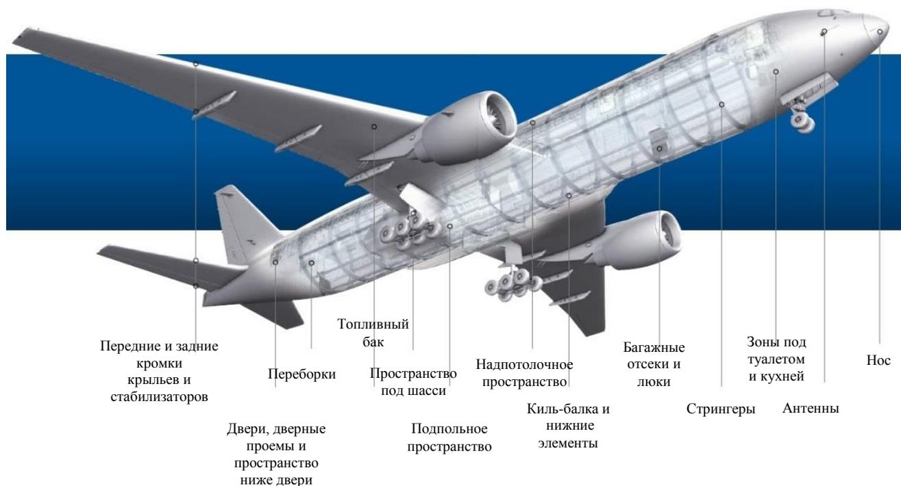
Рисунок 1.5 – Коррозионно-опасные зоны самолета
