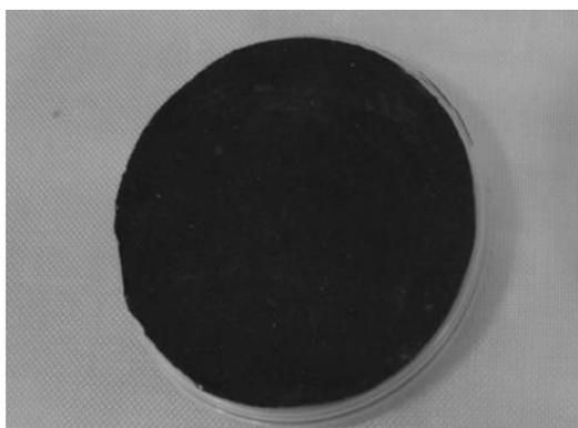
Рисунок 2.7 – Образец вулканизата для определения твердости по Шору А
