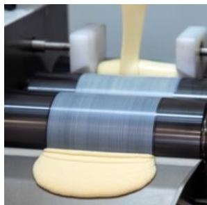
Рисунок 2 – Процесс перетирания компонента А
