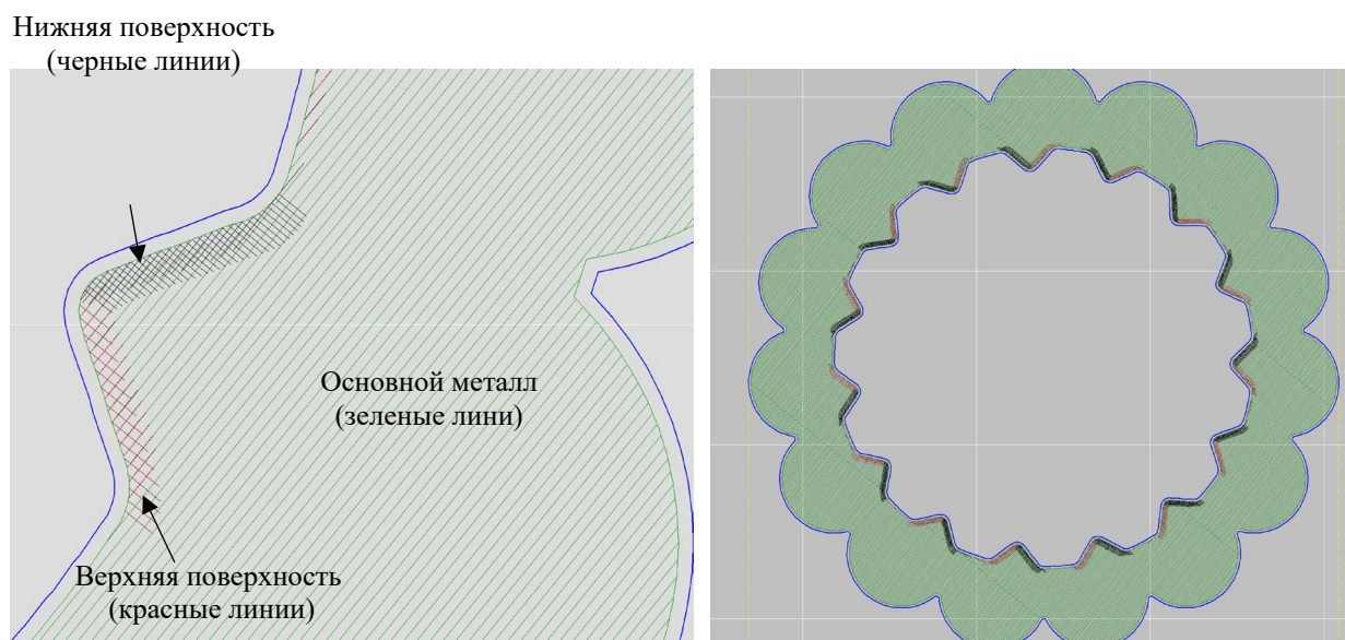
Рисунок 4.12 – Визуализация траекторий движения лазера по актуальным составляющим комплексного режима на примере сечения сложнопрофильной детали
