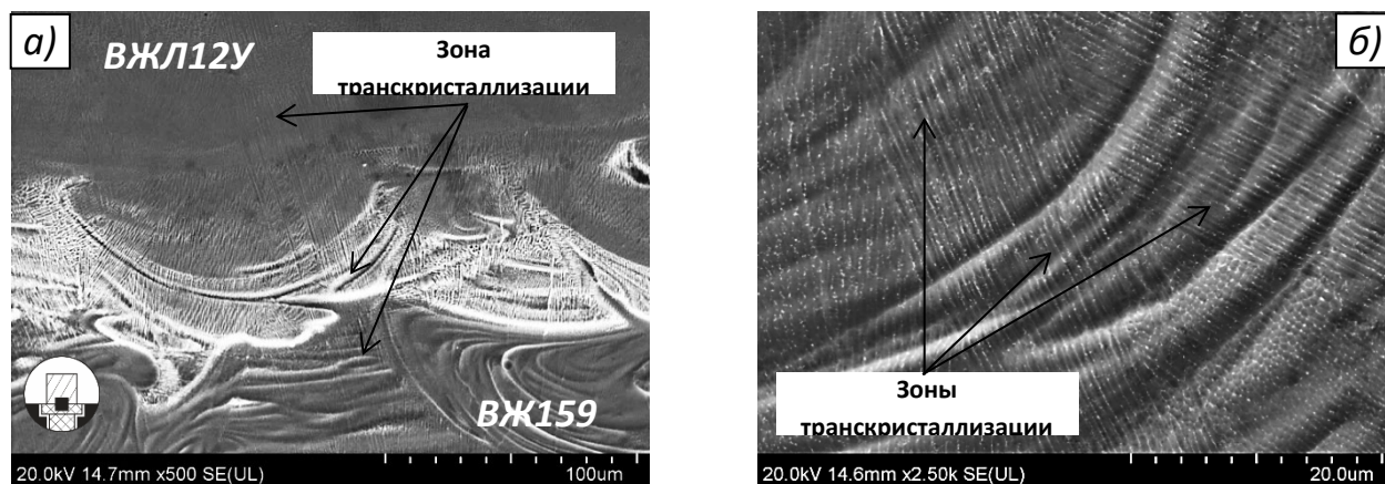
Рисунок 3 – Микроструктура переходной зоны образцов сплава ВЖЛ12У, нанесенного методом СЛС на подложку из СЛС-сплава ВЖ159, в зоне смешения после электролитного травления (а, б)
