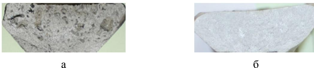
Рисунок 4. Вид изломом образцов сплава МЛ10 системы Mg-PЗЭ-Zr полученных без рафинирования флюсом (а) и с флюсом Ф-2 (б)
