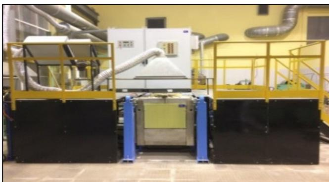
Рисунок 1. Индукционная плавильная установка ИСТ-0,05/0,1
