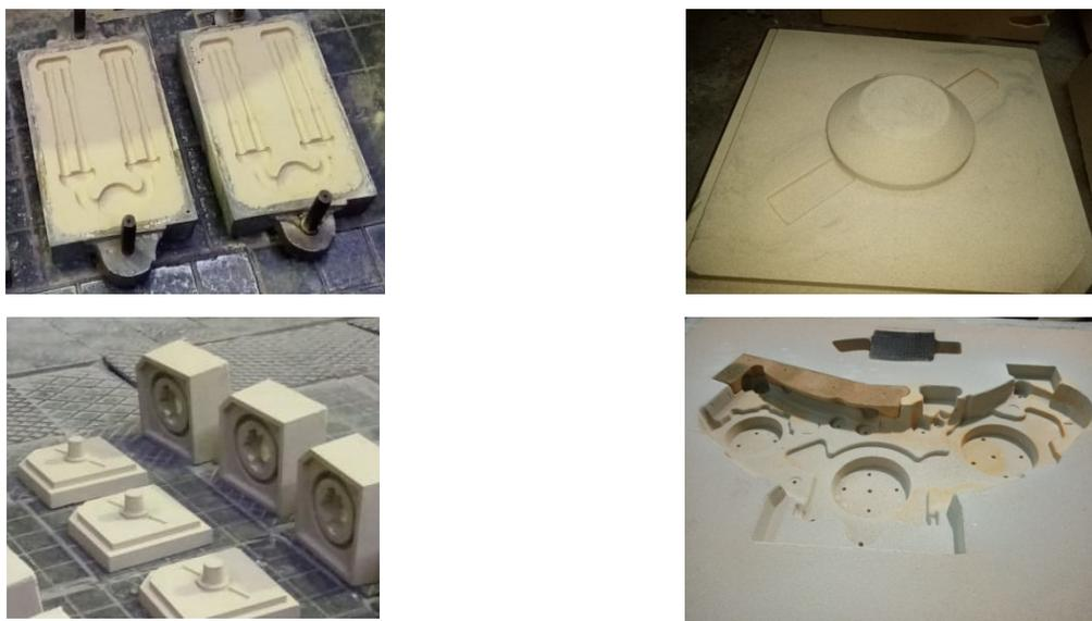
Рисунок 14. Формы, изготовленные из холоднотвердеющей смеси с использованием регенерированной смеси.
