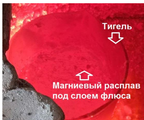
Рисунок 3. Поверхность магниевого расплава МЛ5пч системы Mg-Al-Zn под универсальным чешуирующим флюсом Ф-2.
