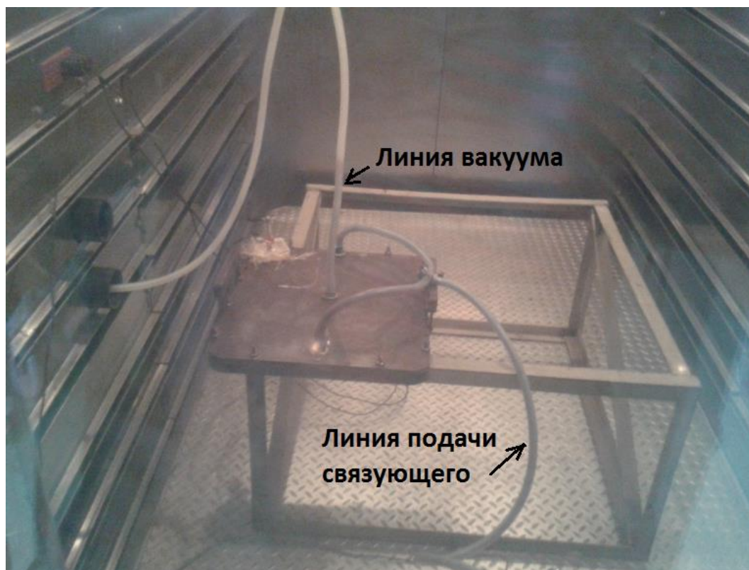
Рисунок 52 –Пропитка под давлением в присутствии вакуума
