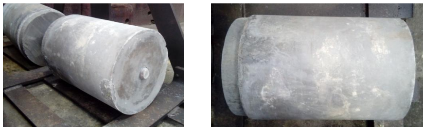
Рисунок 6 – Слитки сплава ВМД16 Ø 365 мм, масса ~135 кг (общий вид)
