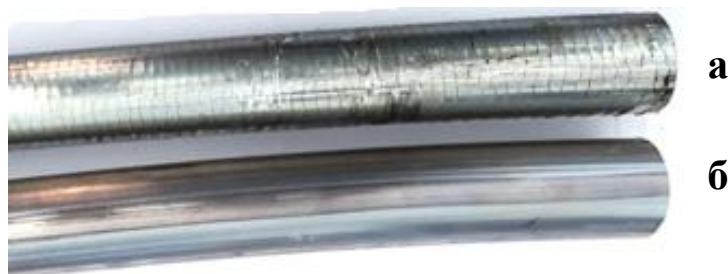
Рисунок 13 – Внешний вид прутков (срединная часть) из сплава ВМД16: а – пруток, отпрессованный в интервале температур 405 - 410 °С; б – пруток, отпрессованный в интервале температур 415 - 450 °С
