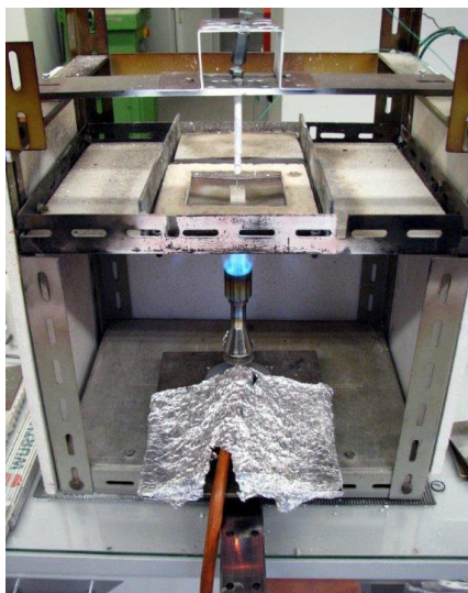
Рисунок 34. Малоразмерный стенд для проведения огневых испытаний на воспламеняемость образцов магниевых сплавов
