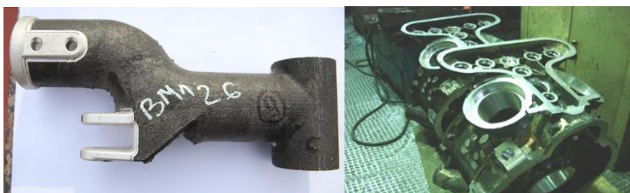
Рисунок 38. Отливки из разработанных литейных магниевых сплавов
