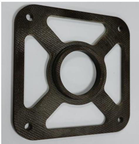
Рис. 48 – Заготовка электроизоляционной вставки из стеклопластика ВПС-72
