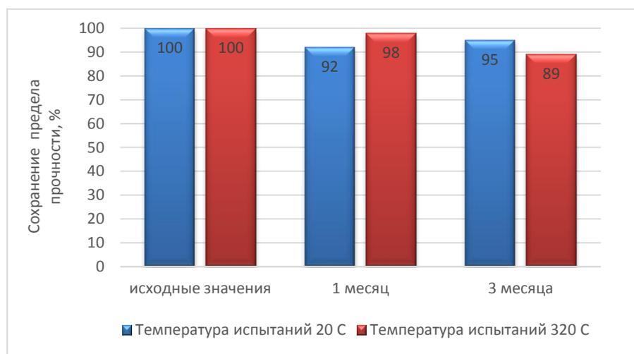
Рис. 41 – Зависимость сохранения предела прочности при изгибе стеклопластика ВПС-72 после экспозиции в термовлажностной камере (1 и 3 месяца)
