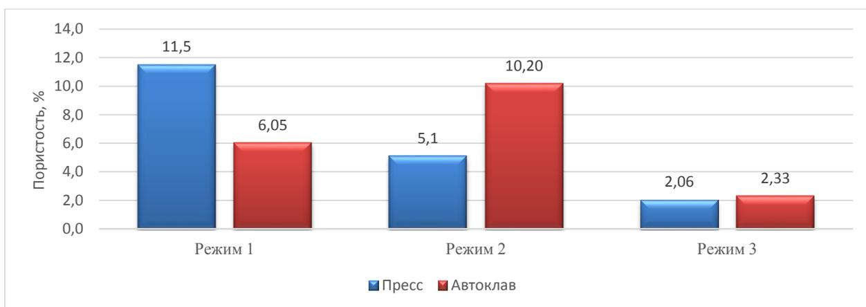
Рис. 24 – Влияние технологии и параметров формования на пористость образцов стеклопластиков на основе связующего ВС-51 и стеклоткани Т-10-14
