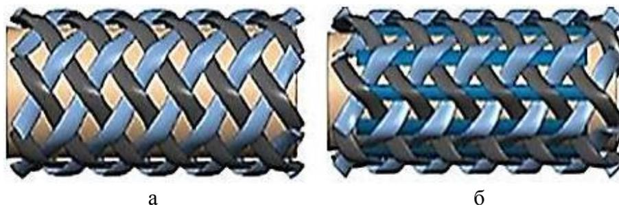
Рисунок 24 – Схемы армирования плетеных преформ: а – биаксиальное плетение, б – триаксиальное плетение
