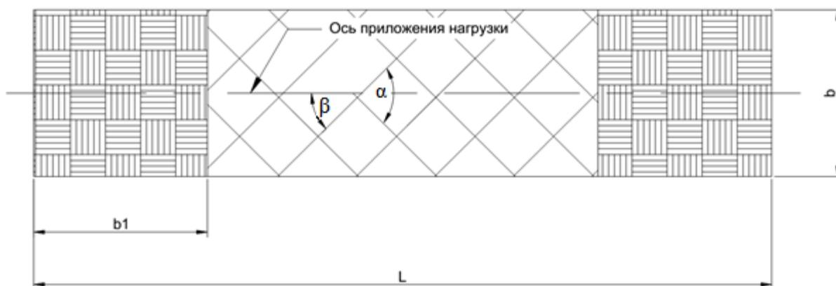
Рисунок 34 – Схематичное изображение образца углепластика с конструкционной укладкой:  $\alpha$ - угол укладки армирующего наполнителя,  $\beta$ -угол между осью приложения нагрузки и осью армирования, L- длина образца, b- ширина образца,  $b_1$ - длина зоны зажима.
