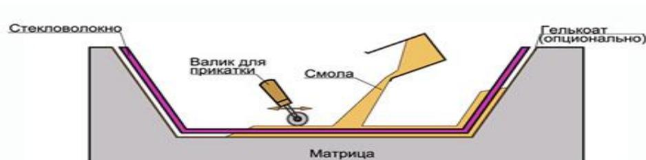
Рисунок 1 - Схема процесса изготовления изделий из ПКМ способом контактного формования
