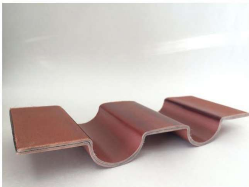
Рисунок 3.16. Элемент конструкции, изготовленный из ПКМ с интегрированным вибропоглощающим слоем.
