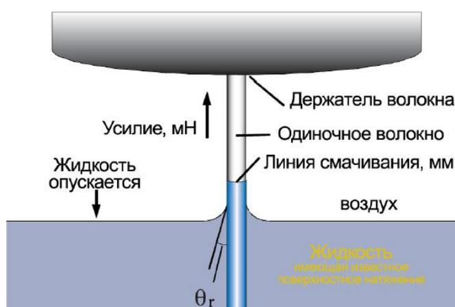
Рис. 15 – Схема определения краевого угла смачивания нити.
