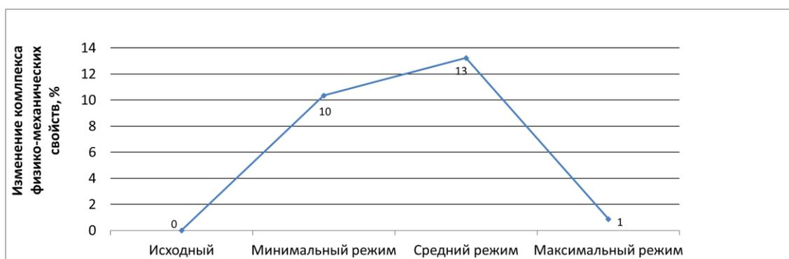
Рис. 39 – Общее изменение комплекса физико-механических свойств стеклоуглепластика на основе связующего марки ВСЭ-65 и наполнителей, модифицированных ионно-плазменной обработкой по различным режимам
