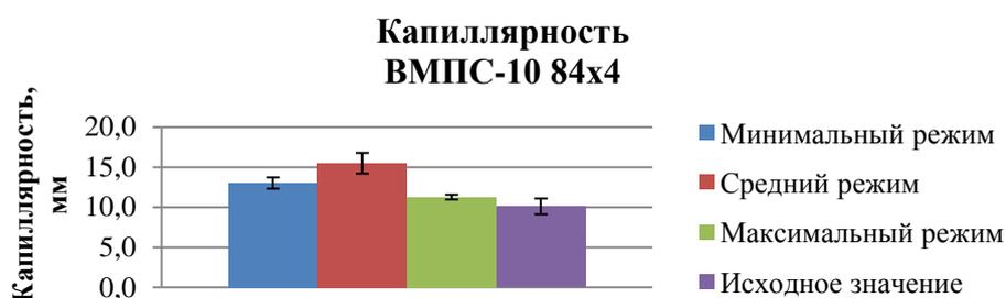
Рис.29 – Значения капиллярности стеклянных волокон, обработанных при атмосферном давлении по трем режимам в сравнении с исходными
