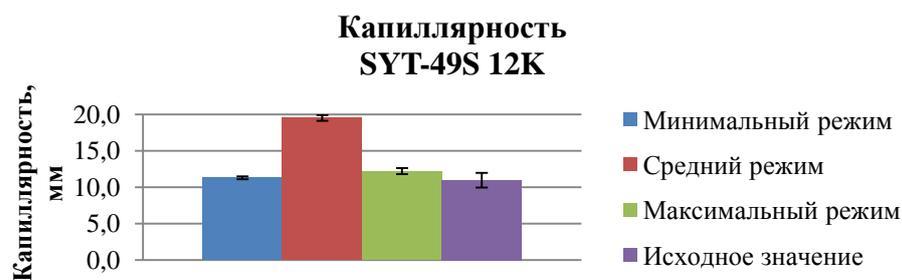
Рис. 30 – Значения капиллярности углеродных волокон, обработанных при атмосферном давлении по трем режимам в сравнении с исходными
