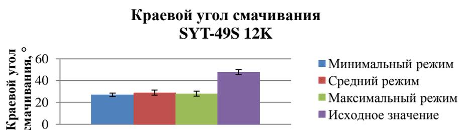
Рис. 28 – Значения краевого угла смачивания углеродных волокон, обработанных при атмосферном давлении по трем режимам в сравнении с исходными
