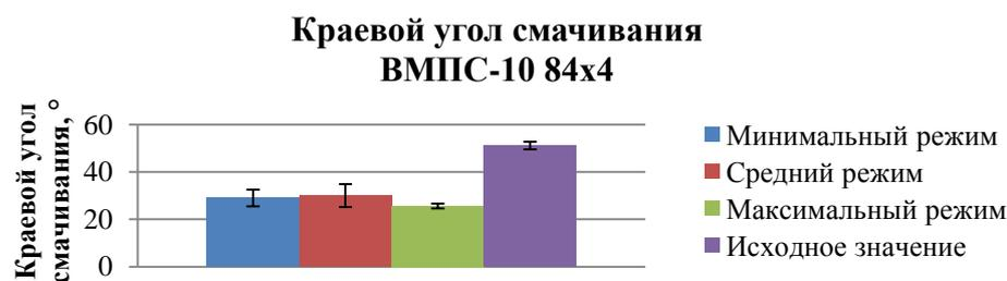
Рис. 27 – Значения краевого угла смачивания стеклянных волокон, обработанных при атмосферном давлении по трем режимам в сравнении с исходными
