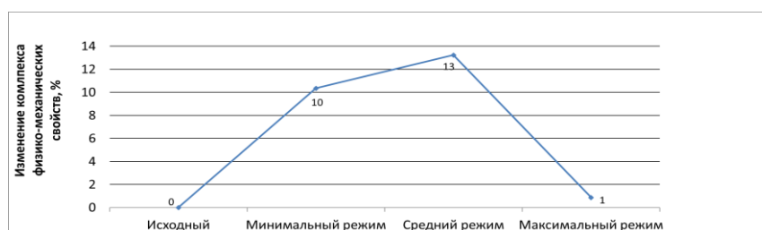
Рисунок 8 - Совокупное изменение комплекса физико-механических свойств стеклоуглепластика на основе связующего марки ВСЭ-65 и наполнителей, подвергнутых ионно-плазменной обработке по различным режимам
