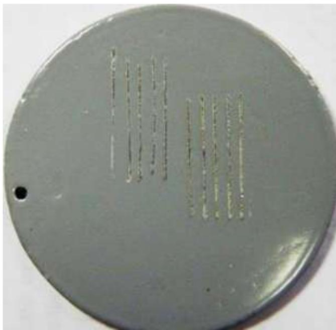
Рисунок 3.30 - Внешний вид образца сплава МЛ5 с ПЭО покрытием, окрашенный системой ЛКП (грунтовка ЭП-0215 + фторполиуретановая эмаль)
