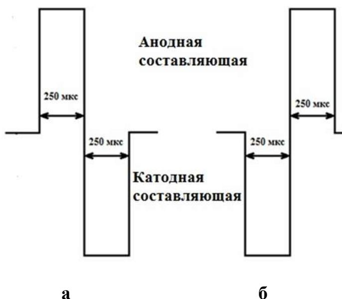
Рисунок 3.13 - Последовательность поляризующих импульсов:
