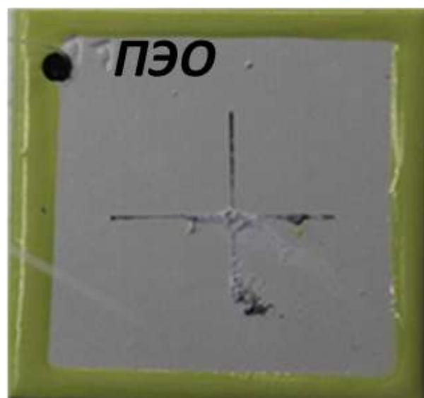
Рисунок 3.31 - Внешний вид образца сплава МЛ5 с ПЭО покрытием, окрашенного системой ЛКП (грунтовка ЭП-0215 + фторполиуретановая эмаль), после экспозиции 720 часов в КСТ
