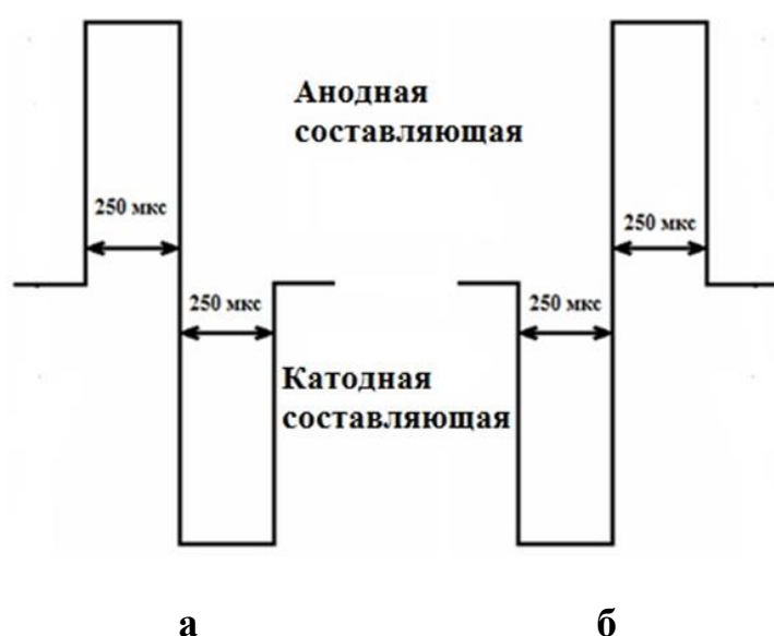
Рисунок 4 – Последовательность поляризующих импульсов: а – режим принудительного окончания горения, б – режим естественного окончания горения
