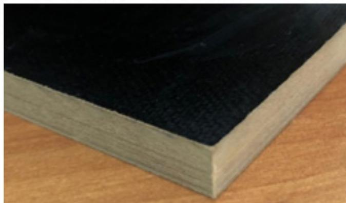
Стеклопластик СТП-97с – высокопрочный трудносгорающий листовый материал на основе конструкционной стеклоткани Т-10-80 и полиимидного связующего СП-97с. Стеклопластик рекомендован для изготовления деталей конструктивно-радиотехнического назначения, эксплуатируемых при температурах до 300–350 °С.
