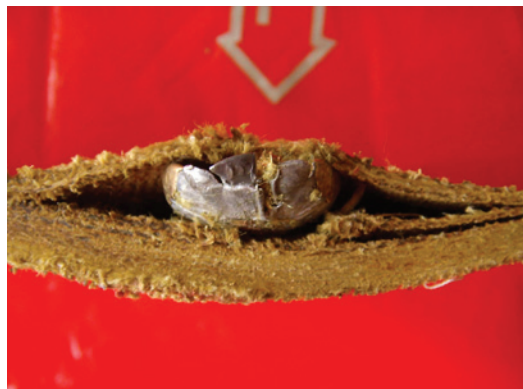
Пуля калибра .44 Магнум между слоями органопластика после баллистических испытаний
