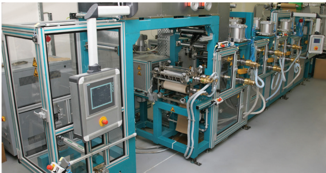
Лабораторная установка для изготовления препрегов Coatema LS-11
