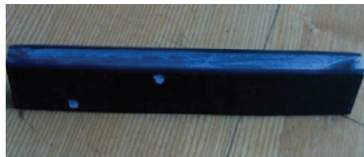
Элемент многослойной конструкции с обшивками из углепластика и средним слоем из синтактного материала
