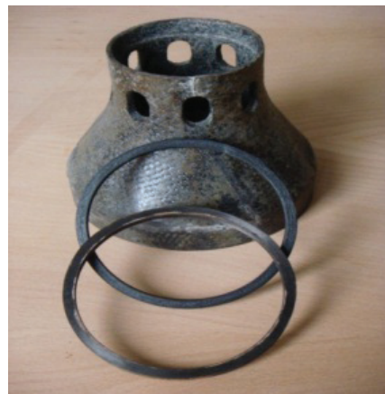
Жаровая труба из квазипластичного керамического композита и фрагмент элемента жаровой трубы и кольца
