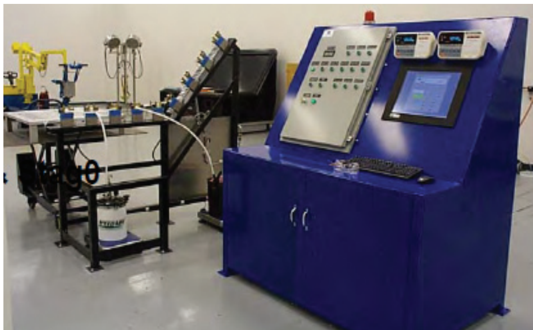
Установка вакуумной инфузии
