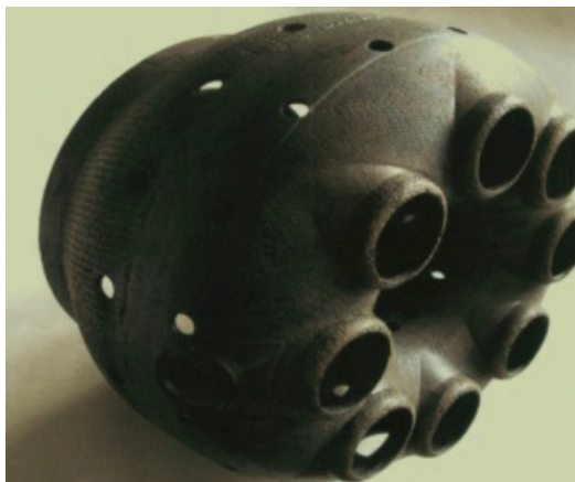
Жаровая труба из квазипластичного керамического композита и фрагмент элемента жаровой трубы и кольца
