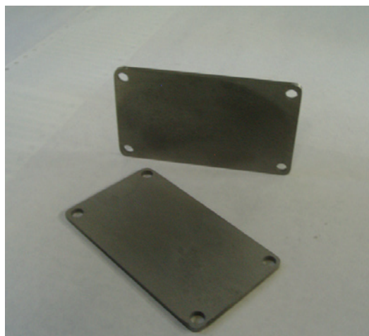
Теплоотводящие основания из МКМ системы Al—SiC
