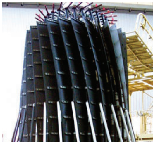
Развертывающаяся в космосе антенна радиотелескопа
