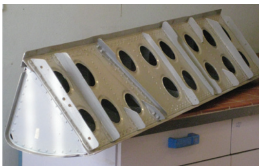
Носовая часть крыла самолета Ан-124 с обшивками из алора Д16/41
