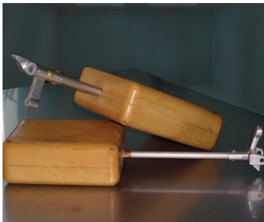
Попловок-уровнемер из пенопласта ПУ-107
