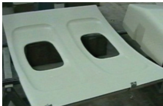
Элемент интерьера из трехслойной сотовой панели (оконная панель изделия Ту-204)
