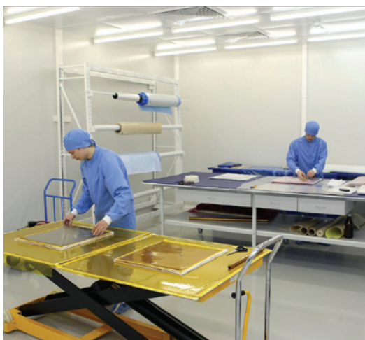
Выкладка препрега для автоклавного формования в помещении «чистая комната»
