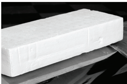
Материал на основе волокон оксида алюминия с рабочей температурой до 1700°C
