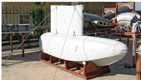
Площадка для испытаний узлов и конструкций в свободном состоянии. Поплавок гидросамолета с пилоном
