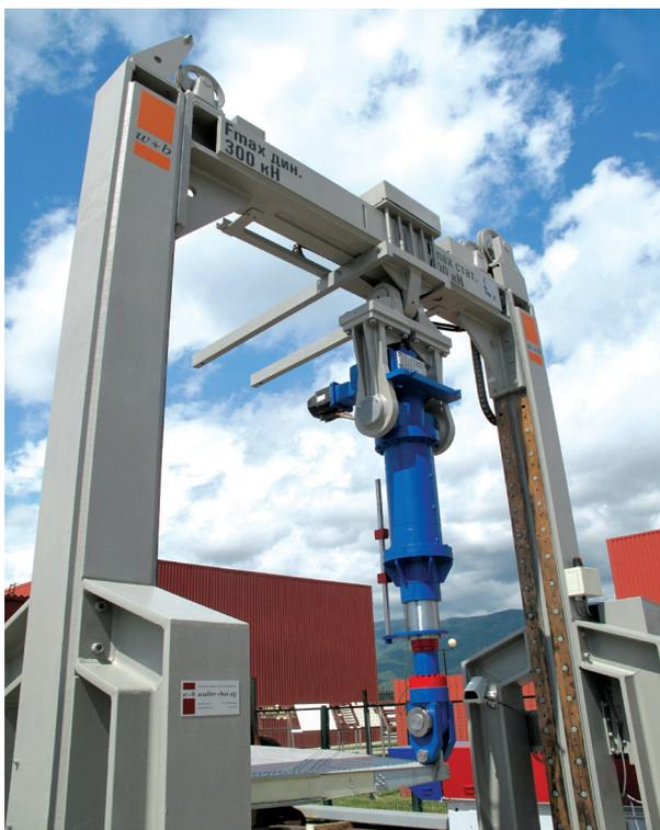
Стенд для климатических испытаний крупногабаритных конструкций производства фирмы «Walter+Bai AG»
