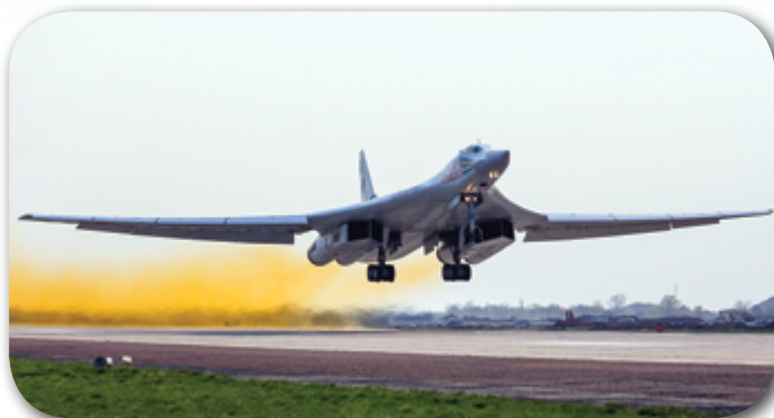
Самолет Ту-160. Верх крыла изготовлен из сплава В95п.ч., низ крыла и обшивка фюзеляжа — из сплавов Д16ч. и 1163. Силовой каркас — из сплавов В93ч. и 1933
