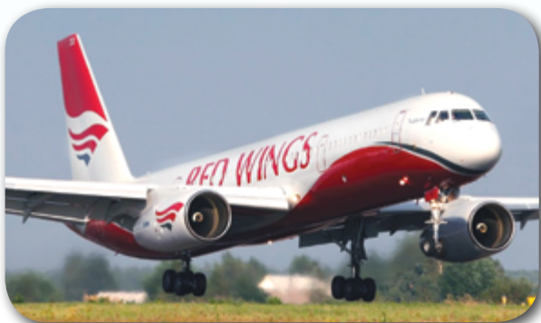
Новый магистральный самолет для линий средней протяженности Ту-204. Верх крыла изготовлен из сплава В95о.ч., низ крыла и обшивка фюзеляжа — из сплава 1163. Силовой каркас — из сплава 1933. В ряде деталей использован сверхлегкий Al-Li сплав 1420
