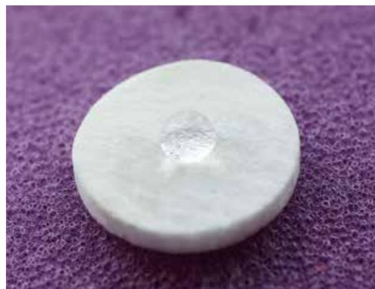
*Разработаны новые технологии гидрофобизации волокнистых керамических высокопористых материалов с использованием методов сверхкритических флюидов (подана заявка на патент).*
