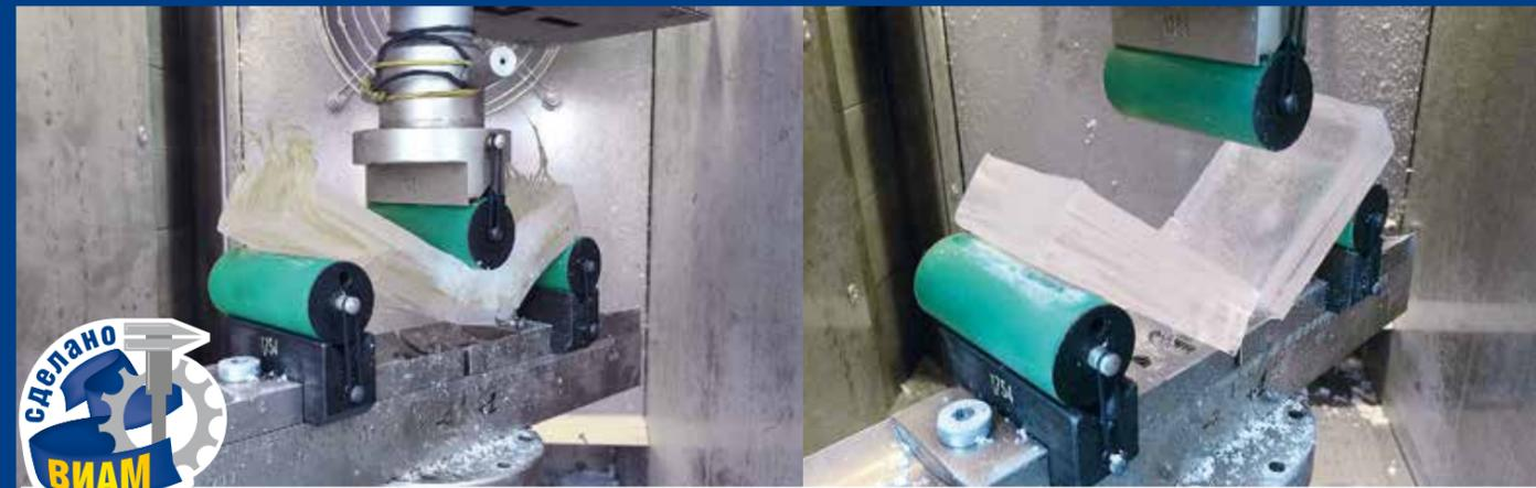
Проводятся исследования по созданию композиционных материалов на основе ледяной матрицы. Армирование позволило увеличить прочность льда в 3–4 раза и снизить деформацию в 30–50 раз.
