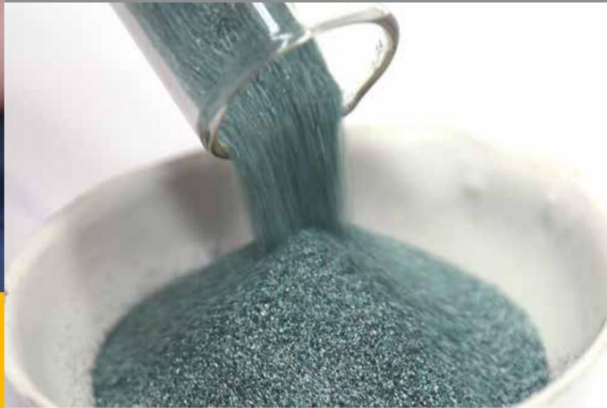
Применение высокотемпературного химического синтеза не предусматривает использование высокотехнологичного, ресурсоемкого аппаратного оформления. Нанесение и формирование покрытия на УУКМ осуществляется шликерно-обжиговым методом, который позволяет получать покрытие на крупногабаритных деталях авиакосмической техники, выполненных из C–C, C–SiC, SiC–SiC.
