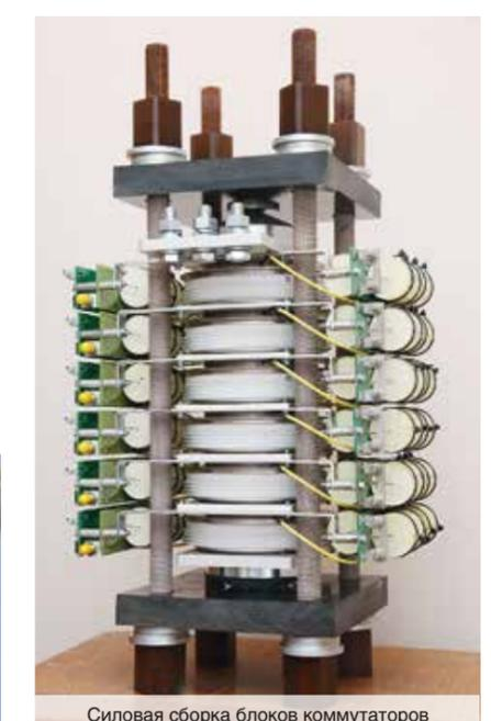
Силовая сборка блоков коммутаторов
