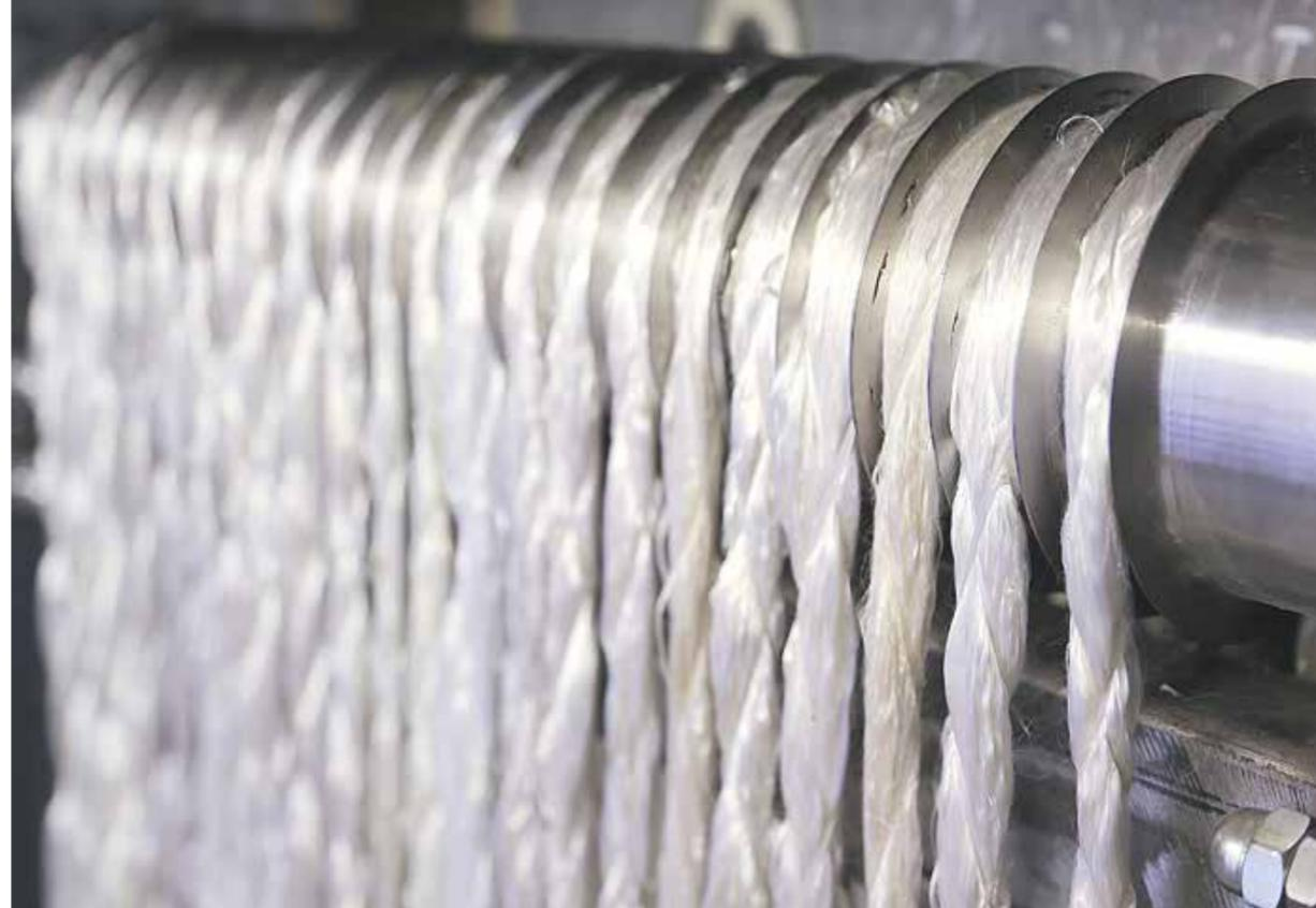
Волокно необходимо при изготовлении конструктивных ПКМ для изделий авиационной и ракетно-космической техники, а также для создания широкополосных радиопоглощающих материалов гражданского назначения.
