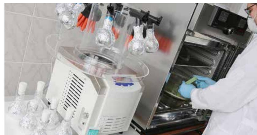
Созданы комплекс для проведения испытаний материалов на стойкость к воздействию климатических факторов – 11 единиц испытательного оборудования (камеры холод–тепло–влага, камеры имитации тропического климата, камеры холод–тепло, камеры воздействия солнечной радиации и камера циклического воздействия температур) и комплекс тепловых ресурсных испытаний – 52 единицы испытательного оборудования (диапазон температур от 150 до 1500°С).
