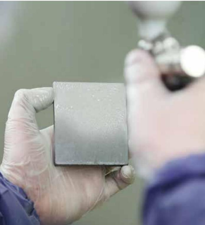
Разработанная система антиокислительных покрытий обеспечивает защиту углеродсодержащих композиционных материалов в условиях воздействия окислительной среды и потоков диссоциированного воздуха. Для получения антиокислительного покрытия используется метод высокотемпературного химического синтеза, преимуществом которого является формирование покрытия при температурах ниже температуры эксплуатации на 500–600°C.
