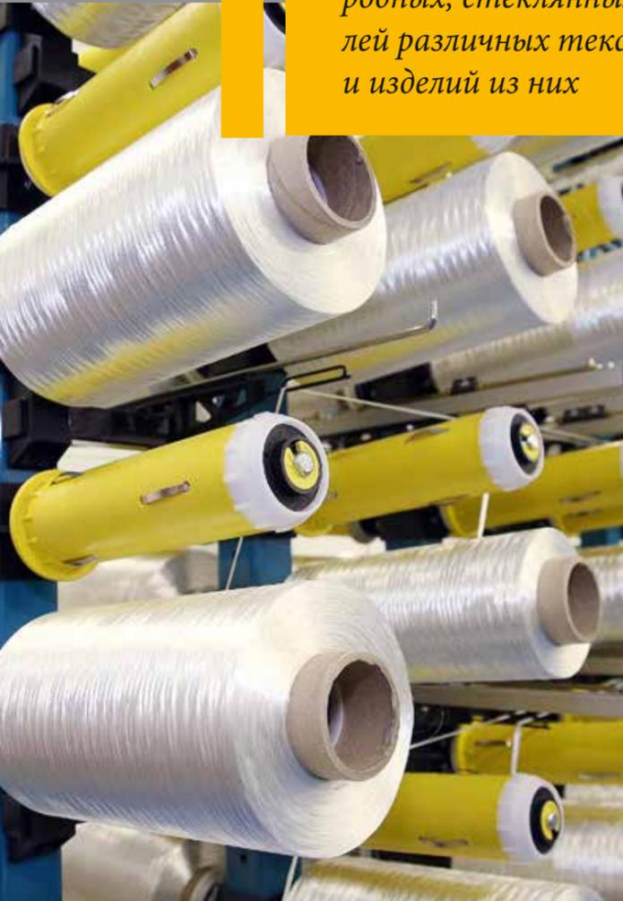
В период с 2012 по 2017 год разработано более 70 новых марок ПКМ с диапазоном рабочих температур от 80 до 350°C на основе стеклянных, органических и углеродных армирующих наполнителей с различными текстильными формами. Разработанные ПКМ предназначены для изготовления деталей и агрегатов по различным технологиям, таким как препреговая с последующим автоклавным или вакуумным формованием, пропитка под давлением, вакуумная инфузия и др.
