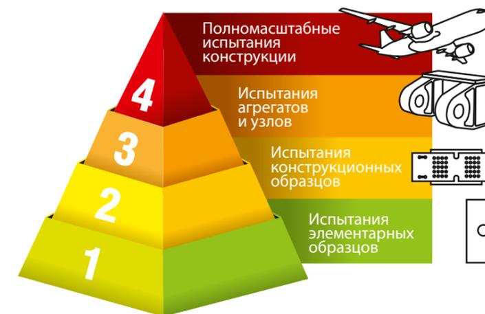
Пирамида испытаний, обосновывающая правомерность применения материала в конструкции
