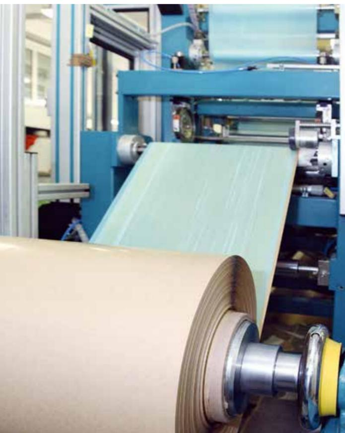
Разработана серия препрегов угле- и стеклопластиков, изготавливаемых по расплавной технологии, на основе высокодеформативного эпоксидного связующего ВСЭ-1212 на рабочую температуру 120°C, в том числе для автоматизированной выкладки лентами шириной 150 мм на станках АТЛ и шириной 6,35 мм для укладки на роботах и станках АРР.
