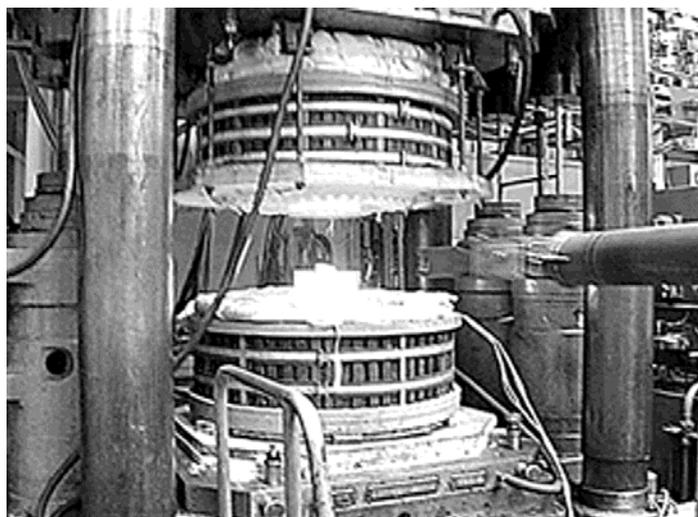
Рисунок 7. Внешний вид штамповки из пресс-прутка сплава ЭП975 на заключительной операции деформации после подъема выталкивателем из штампа прессы усилием 1600 тс
