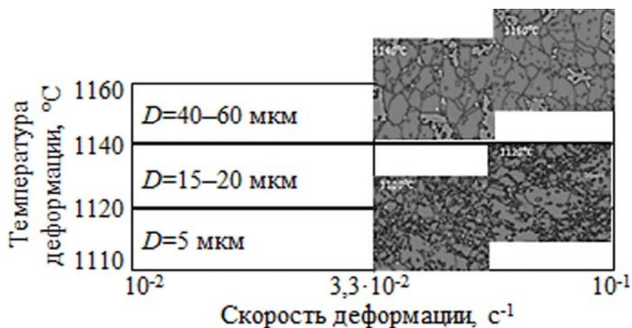
Рисунок 5. Диаграмма структурного состояния сплава ВЖ175-ИД, построенная на основании результатов исследований методом дифракции обратноотраженных электронов ( $D$  – размер рекристаллизованного зерна)
