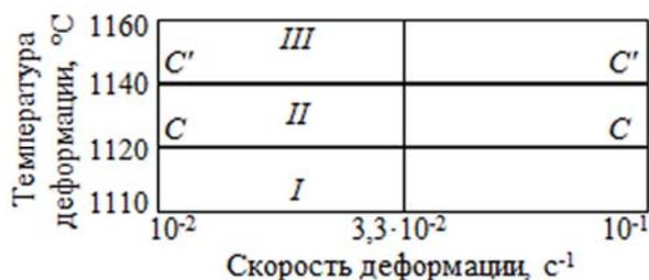
Риснок 6. Диаграмма структурного состояния сплава ВЖ175-ИД, построенная на основании результатов рентгеноструктурных исследований:
