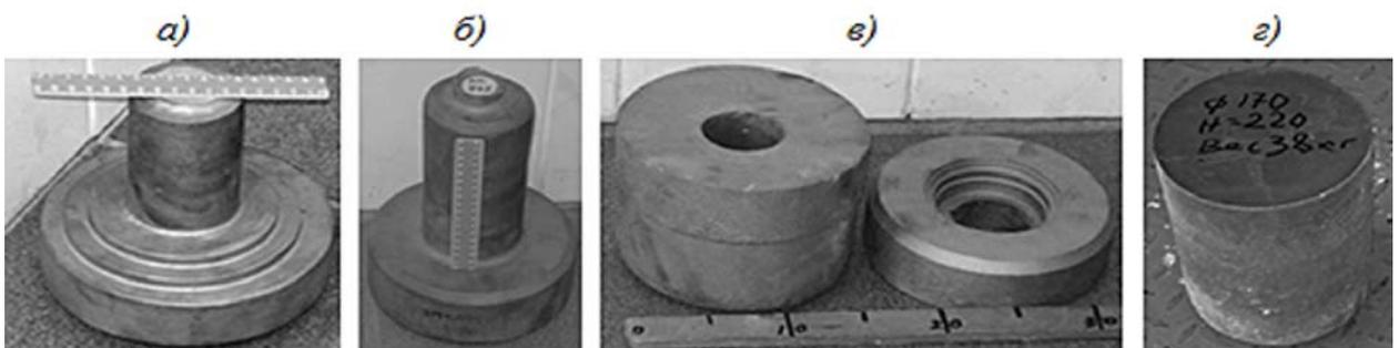
Рисунок 2. Литые заготовки диска переменного сечения (а), диска с валом (б), кольцевые заготовки (в), цилиндрическая заготовка (г) из сплава ЭП975
