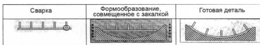
Рисунок 4. Процесс изготовления ребристой сварной панели, включающий формообразование в режиме сверхпластичности
