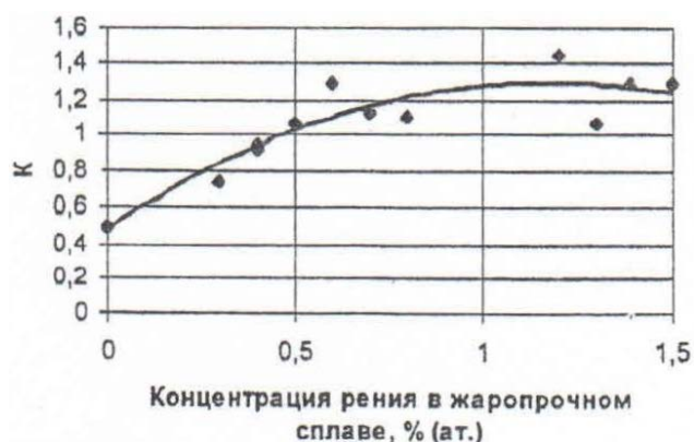
Рисунок 2. Влияние рения на коэффициент распределения вольфрама между \gamma' - и \gamma -фазами жаропрочных никелевых сплавов
