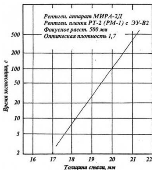
Рисунок 10. Номограмма для определения экспозиций просвечивания сплавов на основе железа импульсным рентгеновским аппаратом МИРА-2Д
