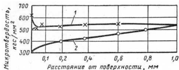
Рисунок 2. Микротвердость поверхностного слоя образцов стали 30ХГСН2А после нагрева при 1180°C, 1 ч и закалки с 900°C:
